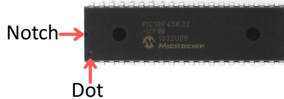
Marquage de polarité et numérotation des broches
